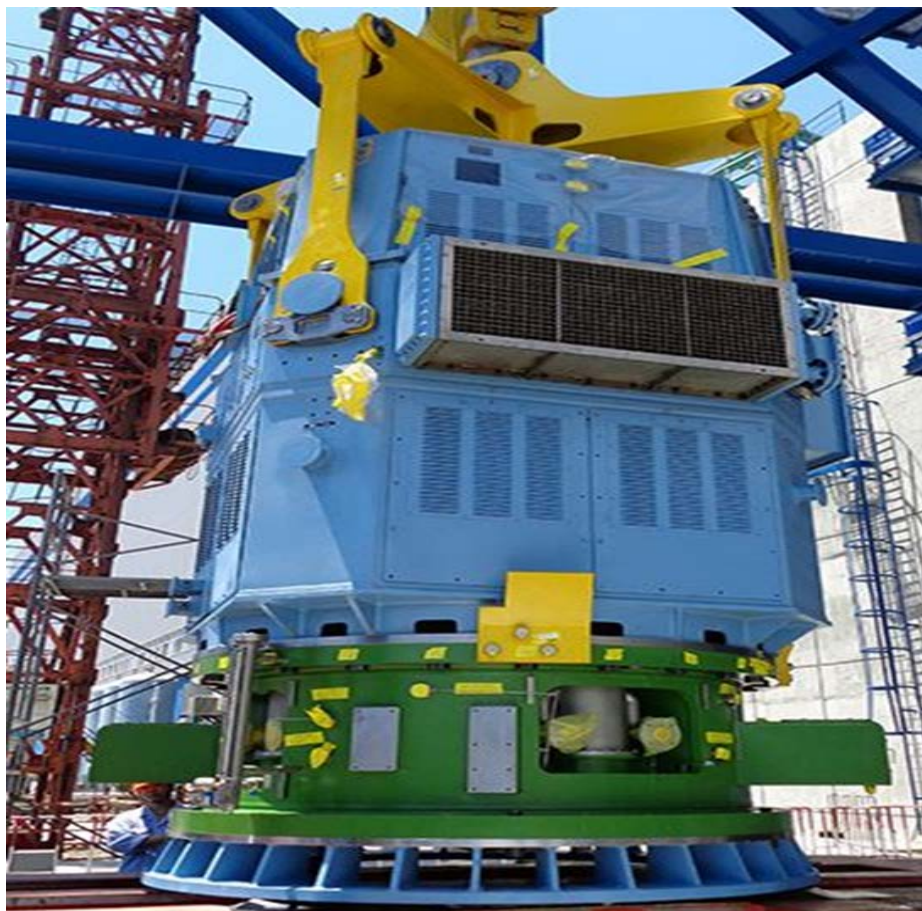
( 1000MW轴封式主泵电动机 )
